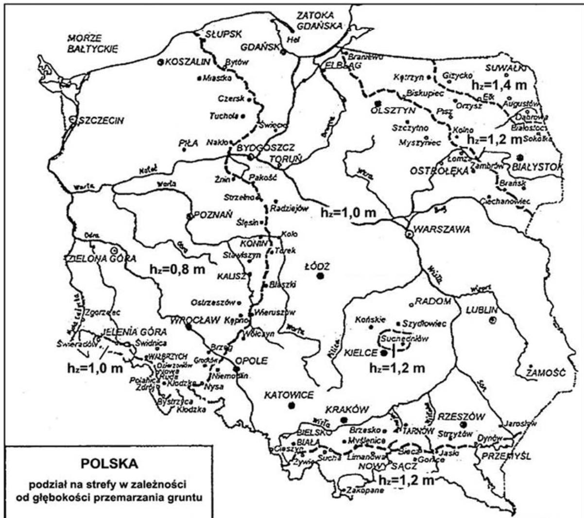
Rys. 6.3 Głębokość przemarzania gruntu  $h_z$  wg PN-81/B-03020
