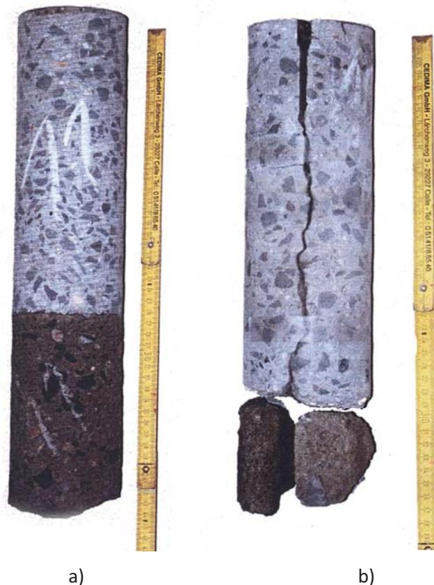
**Rys. 5.65. Widok wyciętej próbki z nawierzchni i podbudowy, a) w środku płyty, b) na krawędzi**
